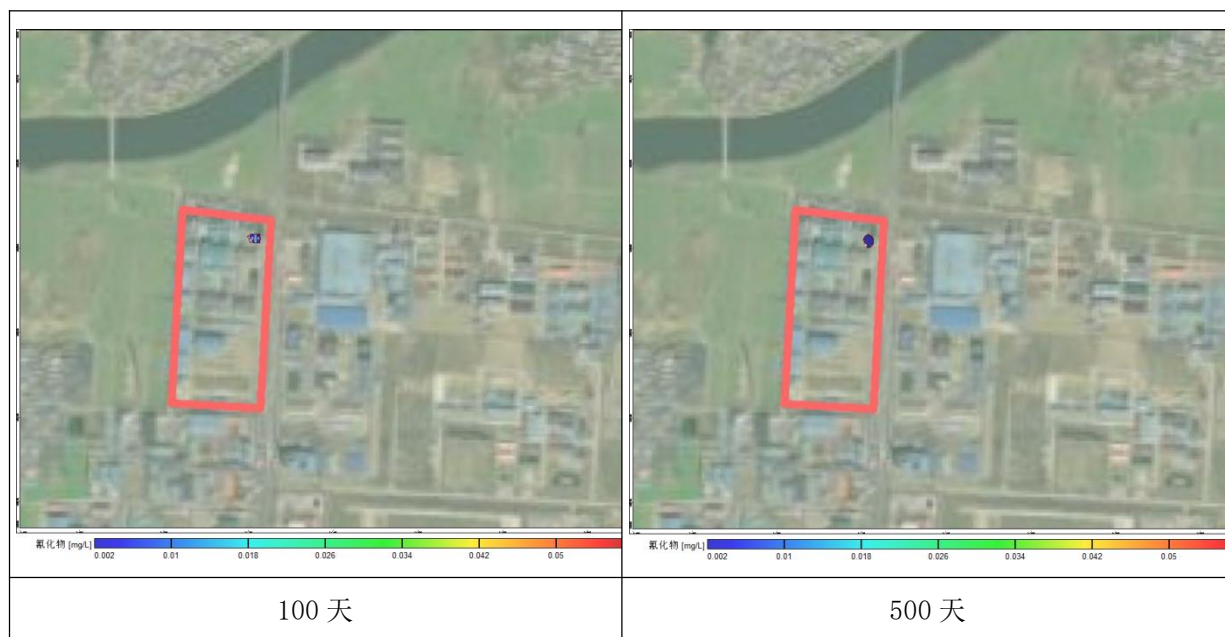
图 5.2-21 氯化物在潜水层运移图
